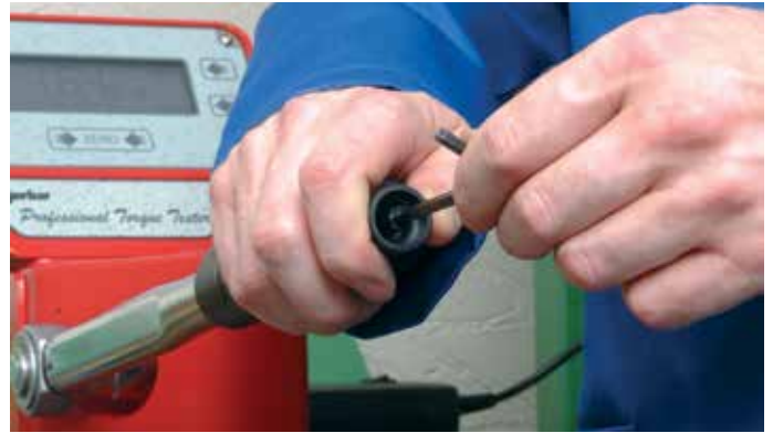
Einstellung eines Drehmomentschlüssels, Typ "P"
